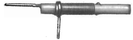
Fig. 2 - Compensatore industriale realizzato secondo la tecnica illustrata nella figura 1. I risultati offerti dagli esemplari «fatti in casa» non si discostano gran che da quelli dei modelli del genere qui fotografato, purché la ceramica impiegata sia di elevata qualità.
