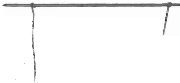
Fig. 3c - Mine «dure» del tipo 3-6 H, possono servire per realizzare resistori semifissi del valore massimo pari a 20-30Ω. Quello qui illustrato (mina 4H) ha un valore massimo di 26 Ω.
