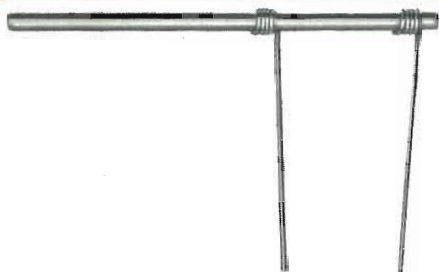
Fig. 3b - Una mina tipo 6B, tenerissima, può essere usata per realizzare un resistore variabile dal valore compreso tra 1,5 e 0,05Ω come questo illustrato.
