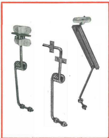
Fig. 9 - Alcuni tipi di carrelli in filo di acciaio. Questi carrelli hanno il pregio di ruotare, per cui il modello può sterzare come un aereo vero.
